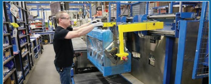
Un travailleur s'active à la finition d'une hotte suspendue grâce à un appareil conçu sur mesure pour manipuler la pièce. Celui-ci peut tourner afin d'accéder à toutes les surfaces, sans avoir recours à la force physique et avec moins de risques.
