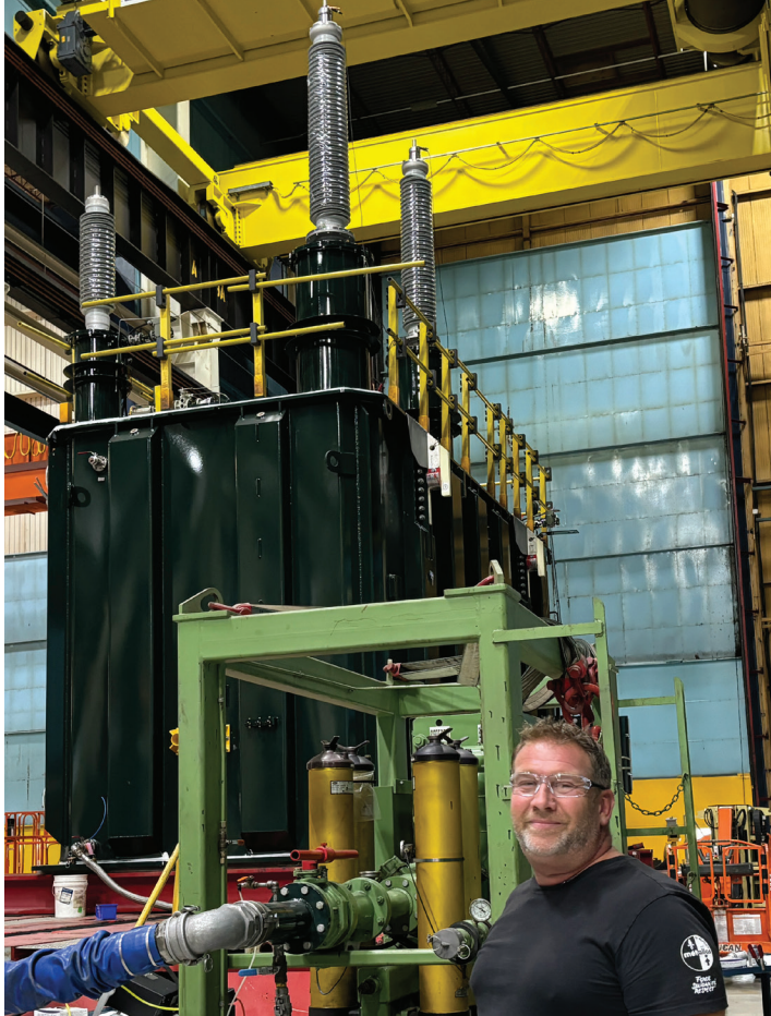
Le président de la SL 9486 chez Hitachi à Varennes, Stéphane Ducharme, devant un transformateur prêt à être testé. L'usine de la Montérégie est la seule en Amérique du Nord à fabriquer des transformateurs de très haut voltage pour les lignes de transport électrique.
